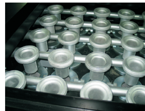
Injektorsäulen mit Injektoren
