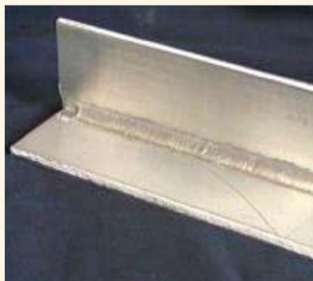
Naht des Titanium mit VPS 4000 digit
