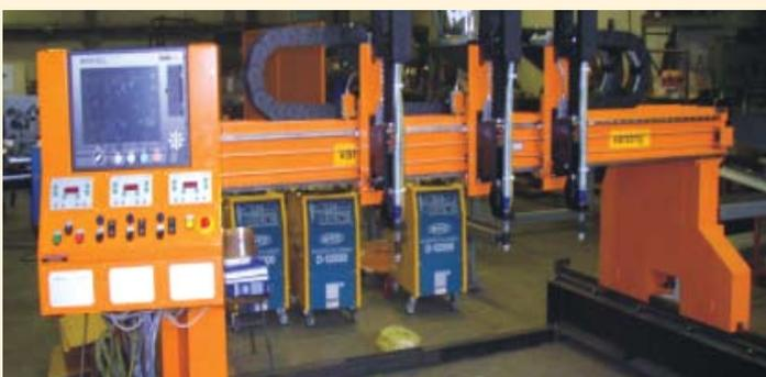
Die CNC Steuereinheiten Burny steuern den Arbeitsprozess der Schneidanlagen durch automatisches oder manuelles Regime.
