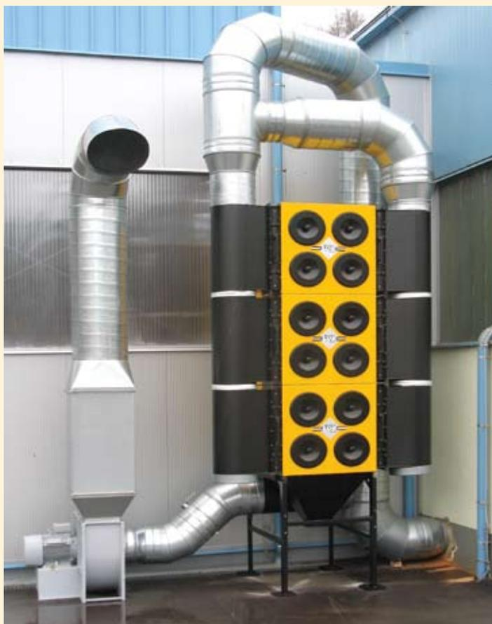
Es sind anpassungsfähige Ausführungen und man benutzt sie bei Absaugsystemen beim thermischen (brenn - plasma) Metallschneiden. Die Geräte sind mit einem System zum automatischen Filterschütteln ausgestattet. Für den Systembetrieb verwendet man bereinigte (ohne Öl) und trockene komprimierte Luft (Druck 5-6 Bar). Die Arbeit wird von der Microprozesseinheit gesteuert. Wichtig ist die korrekte Auswahl des Absaug- und Filtersystemes mit prozessorischem System.
