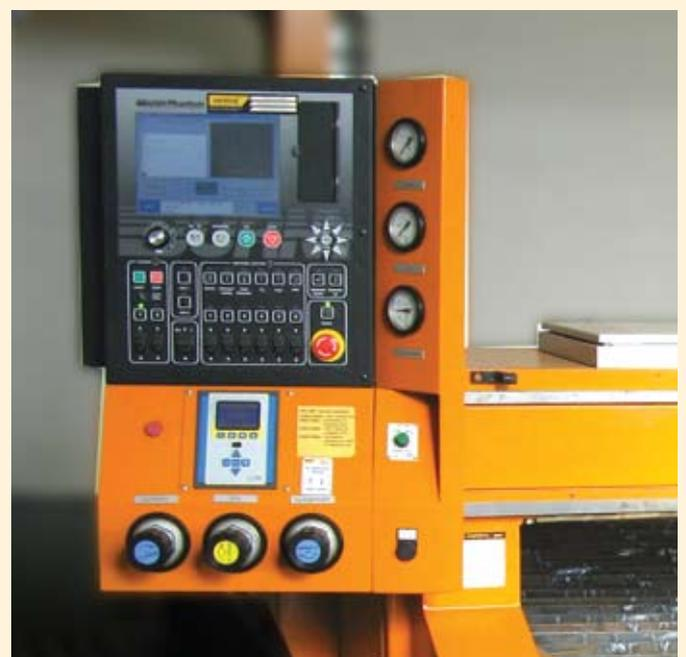
Die CNC Schneidanlagen VARCUT S.PN2N sind präzise und verlässliche Anlagen. Die portal Ausführung der Anlage besitzt einen Schneidekopf zum Plasmaschneiden und zwei Schneidköpfe zum Brennschneiden von Blech mit einem zweiseitigen senkrecht antrieb durch AC Motoren. Die Konstruktion der Schneidanlage mit Ablagetisch ermöglicht die maximale Schneiddicke bis zu 300 mm.
