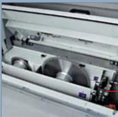
Option Pneumatisches Sperren des Haupt- und Vorritzsägeblatts
