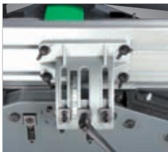
Der Aluminium-Abrichtanschlag ist um 45° neigbar. Die eingestellte Neigung ist bequem an einer Skala ablesbar. (Abbildung zeigt ADH 250)
