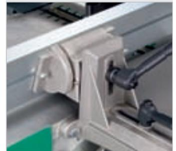
Der Aluminium-Abrichtanschlag ist um 45° neigbar. Die eingestellte Neigung ist bequem an einer Skala ablesbar.
