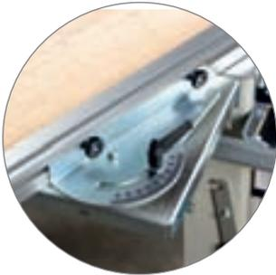
Schiebeschlitten mit Gehrungsanschlag, einstellbar von -45° bis +45° mit Schnellklemmhebel
