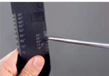
**Schritt 1:** Überprüfung und Bestimmung des Schneidenwinkels.
