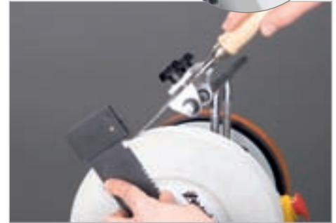
**Schritt 3:** Einstellen der passenden Bügelhöhe zum Schneidenwinkel.
