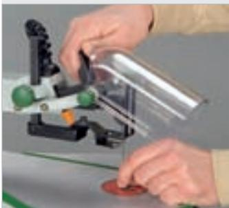
Über den Schnellspannhebel kann das Sägeblatt in Sekunden gewechselt werden, ohne die Grundeinstellung der Sägeblattspannung verändern zu müssen.
