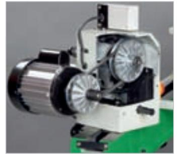
Variable Drehzahlregulierung von 500 - 2.000 1/min. über Keilriemen und verstellbare Konusscheiben.
