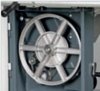
Die 2-stufige Geschwindigkeitsverstellung erfolgt bei der HBS 351-2 manuell durch Umlegen des Riemens. Ausgestattet mit Spänebürsten für freie Laufflächen der Antriebsräder.
