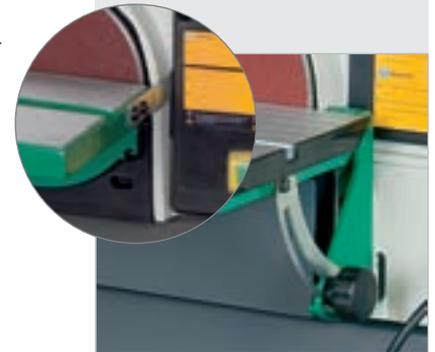
Die Schleiftische des BTS 150 und BTS 250 sind für mehr Stabilität jeweils beidseitig geführt.
