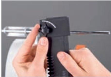
**Schritt 2:** Einstellen des ausgemessenen Schneidenwinkels.
