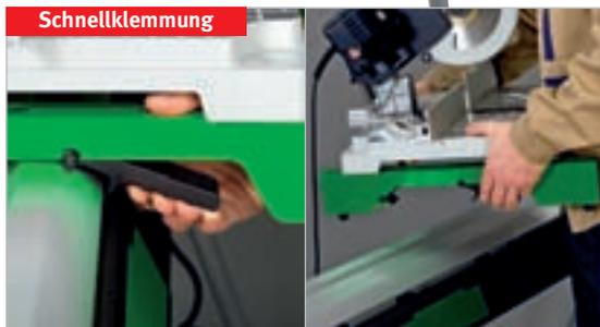
Die Halteschienen können einfach und bequem über ein Schnellklemm-System positioniert, verschoben oder abgenommen werden.
