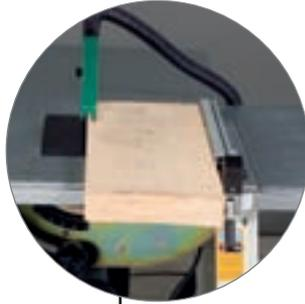
Der Parallelanschlag ermöglicht das Besäumen von Brettern, Auftrennschnitte, Fasen- und Winkelschnitte
