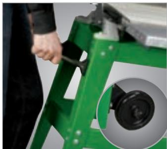
Fahrvorrichtung zum einfachen Verfahren
