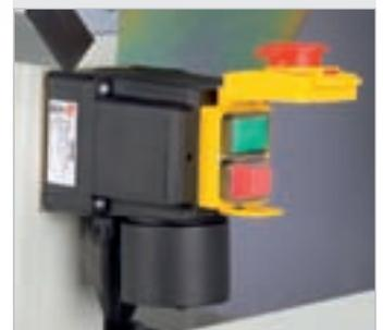
Die Schalter-Stecker-Kombination mit Not-Ausschalter ist abschließbar. Die TKS 315 Pro ist in 230 Volt- oder 400 Volt-Ausführung erhältlich.
