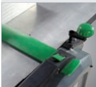
Die Hobelmesser sind durch einen Schutz mit praktischem Schnellspanner abgedeckt. An einer Handkurbel kann die gewünschte Späneabnahme für das Dickenhobeln bis zu 3 mm einfach eingestellt werden. Sie ist an einer Skala bequem ablesbar (Abbildung zeigt ADH 250).
