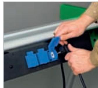
Drei integrierte 230 V Steckdosen auf der Bedienerseite.
