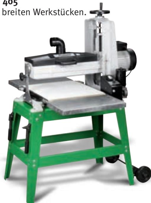
Für eine Wickelung werden ca. 2,5 m Schleifband benötigt.
