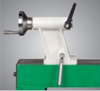
Der Reitstock aus Grauguss wird mittels Klemmhebel schnell und einfach fixiert. Die Verstellung der Pinole erfolgt über ein Handrad.
