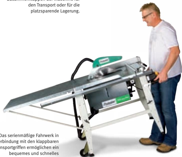
Das serienmäßige Fahrwerk in Verbindung mit den klappbaren Transportgriffen ermöglichen ein bequemes und schnelles Versetzen der Maschine.
