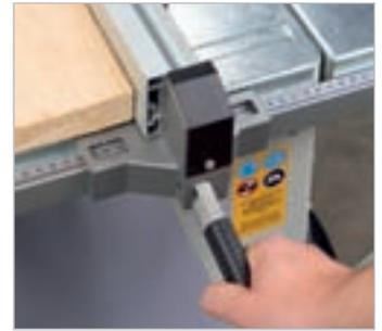
Der Parallelanschlag mit Exzenter-Schnellschraubung kann per Skala präzise und leicht eingestellt werden.
