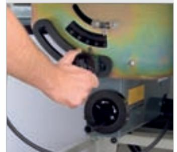
Mit genauer und leichtgängiger Höhen- und Schrägverstellung des Sägeaggregats durch einfach zu bedienende Handräder. Die stabile Aufhängung des Sägeaggregats vorne und hinten ermöglicht präzise Schnitte.
