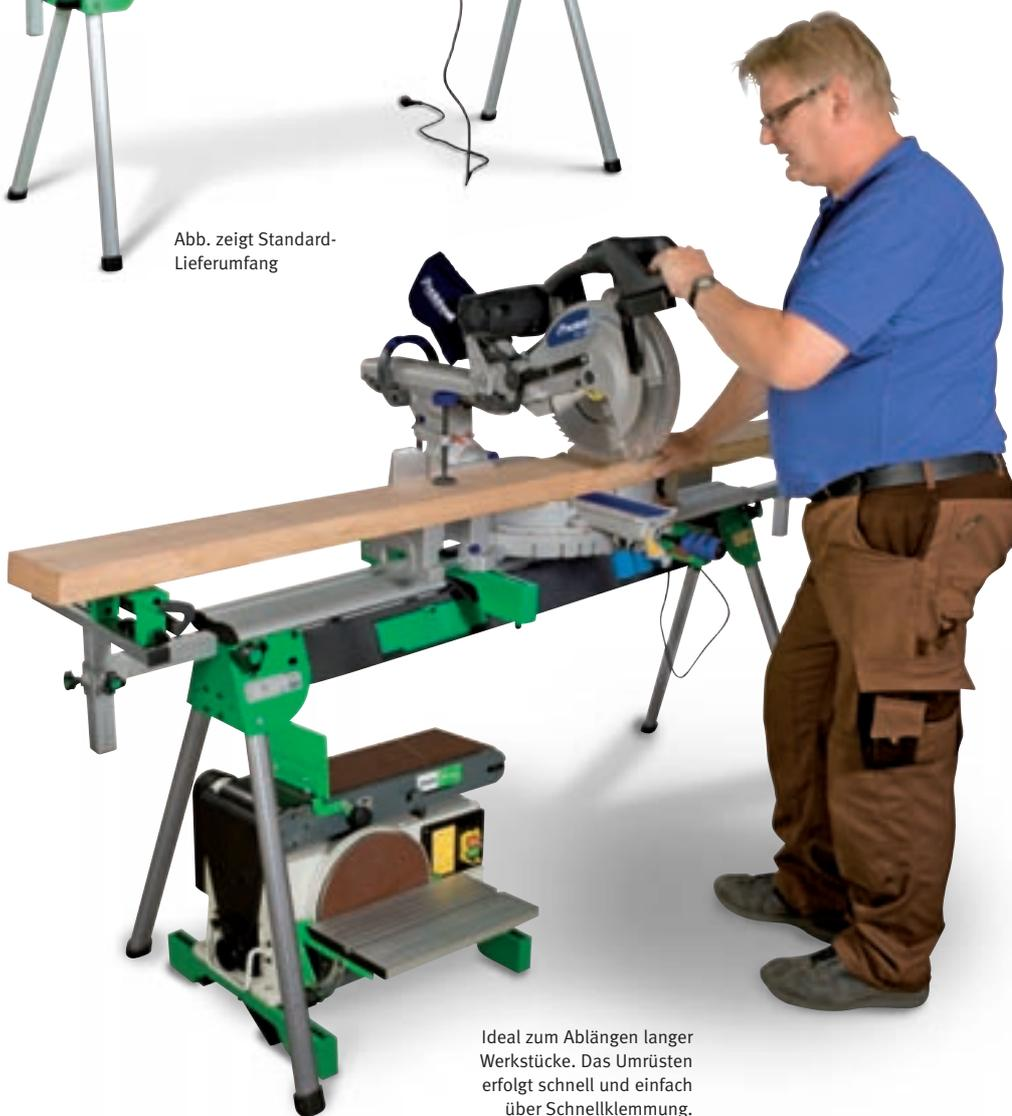
Ideal zum Ablängen langer Werkstücke. Das Umrüsten erfolgt schnell und einfach über Schnellklemmung.
