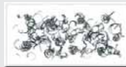
Dünne Späne, die wie Puder aussehen
